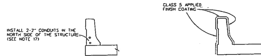
TELEPHONE CONDUIT DETAIL
